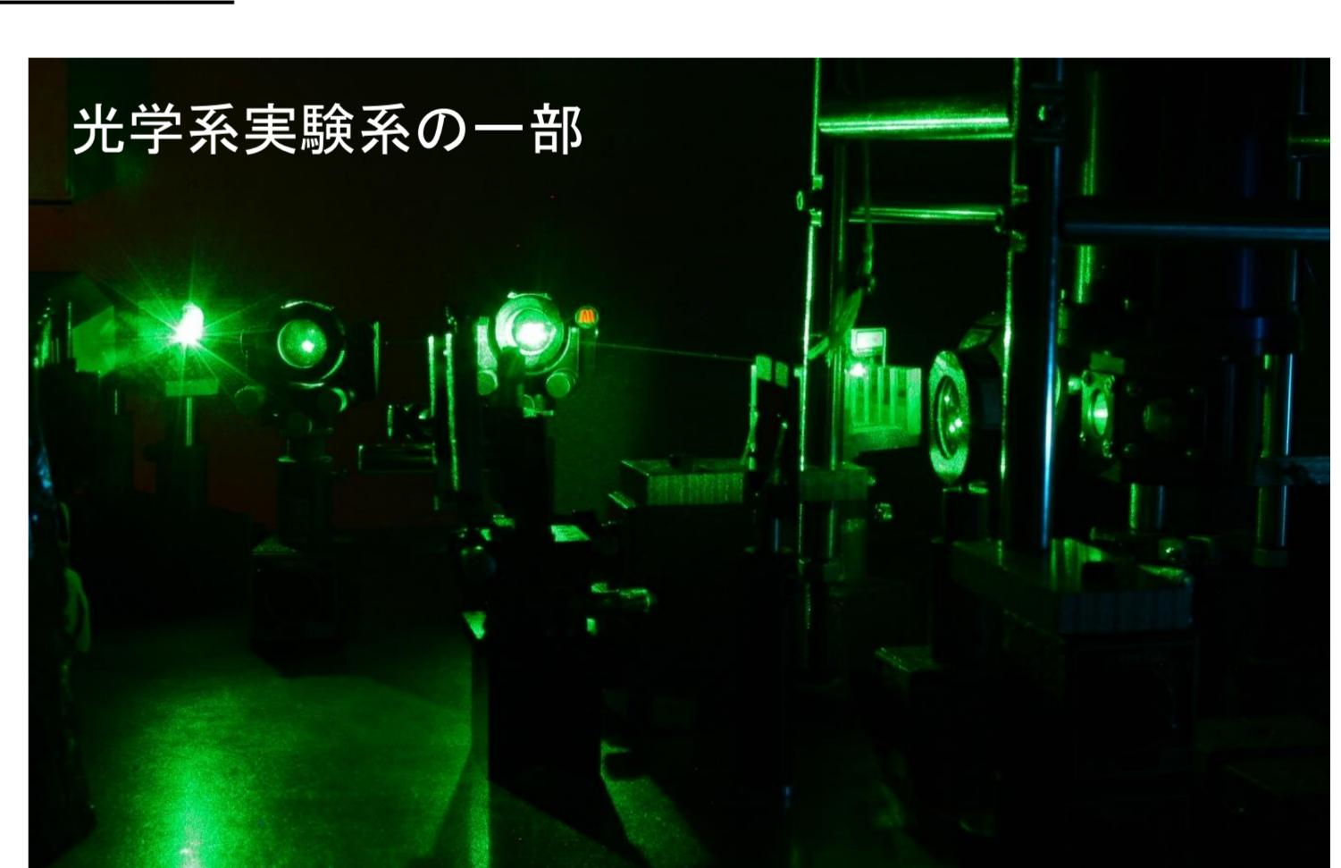
PL観測は、試料にレーザー等の光でエネルギーを与え、発生するキャリアの遷移過程で生じる発光を検出する手法である。この発光スペクトルを解析することで、キャリアの遷移機構や欠陥のエネルギー準位などの半導体の特性がわかる。
